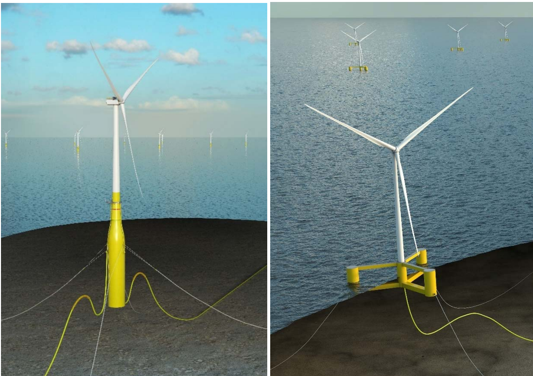
Figur 4-4. Illustrasjon av flytende turbiner med ulike substrukturer; Hywind spar (venstre) og semi (høyre).
